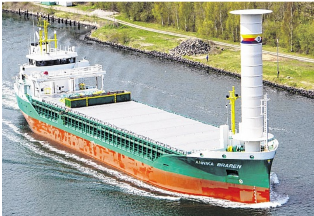
Die „Annika Braren“ nutzt den so genannten Magnus-Effekt mit einem Flettner-Rotor am Bug.
