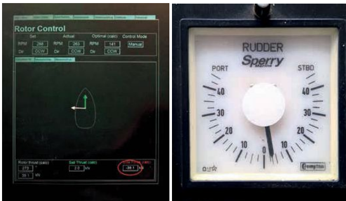
Abb. 5a) und b): Der Bildschirm „Rotor Control“ (links) zeigt eine Rotorquerkraft von 39,1 kN (rot umkreist), die auf das Schiff einwirkt. Der Ruderlagenanzeiger (rechts) gibt an, dass eine Ruderlage von nur ca. 3° nach Steuerbord erforderlich ist, um das Schiff mit dem Autopilot auf Kurs zu halten.
